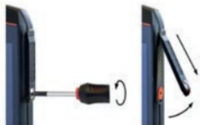
» Löysennä 13-pin ISM-liitännän suojuksen ruuvit toimitukseen sisältyvällä Torx-ruuvitallalla ja poista suojuksia kuvan mukaisesti. Ruuvitallta sisältyy tarvikkeepakaukseen.
