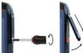
» Lossa skruven på locket till 13-pin ISM-gränssnittet med den tillhandahållna skruvmejseln och ta bort locket som på bild. Skruvmejseln ingår i tillbehörspaketet.
