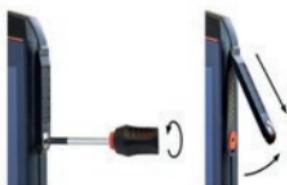
» Maak de schroef op de afdrukking van de 13-pin ISM-aansluiting los met de meegeleverde schroevendraaier en verwijder de afdrukking zoals is getoond. De schroevendraaier maakt deel uit van het pakket accessoires.
