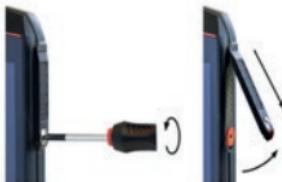
» Løsn skruen på 13-pin ISM-interface dæksel med den medfølgende skruetrækker, og afmonter dækslet som vist. Skruetrækkeren leveres sammen med tilbehørspakken.
