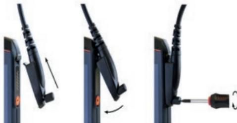
» Liitä hyväksytyn lisälaitteen liitin laitteen 13-pin ISM-liitintään kuvan mukaisesti.
