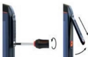
» Allentare le viti sul coperchio dell'interfaccia 13-pin ISM con il cacciavite in dotazione e rimuovere il coperchio come illustrato in figura. Il cacciavite è in dotazione nella confezione dell'accessorio.
