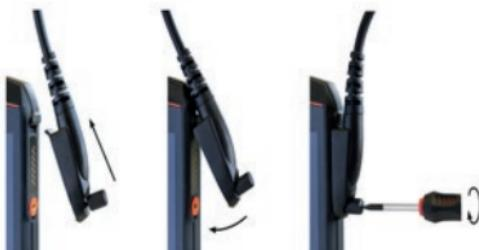
» Verbinden Sie den Stecker des freigegebenen Zubehörs wie abgebildet mit der 13-pin ISM-Schnittstelle.
