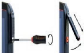
» Lösen Sie die Schraube an der 13-pin ISM-Schnittstellenabdeckung mit dem Schraubendreher der im Lieferumfang des Zubehörs enthalten ist und entfernen Sie die Abdeckung wie abgebildet.
