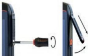
» 付属のドライバーで13-pin ISMインターフェースカバーのネジを緩め、図のようにカバーを取り外します。ドライバーはアクセサリーパッケージに付属しています。
