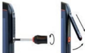
» 使用随附的螺丝刀拧松 13-pin ISM 接口上的螺钉，并如上图所示移除接口盖。附件包装中内含螺丝刀。
