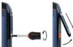
» Ослабьте винт крышки разъема 13-pin ISM отверткой, входящей в комплект поставки, и снимите крышку, как показано на рисунке. Отвертка входит в комплект поставки принадлежности.
