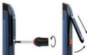
» Za pomocą wkrętaka z zestawu odkręcić wkręty pokrywy interfejsu 13-pin ISM i zdjąć pokrywę, w sposób pokazany. Wkrętak jest zawarty w pakiecie z akcesoriami.
