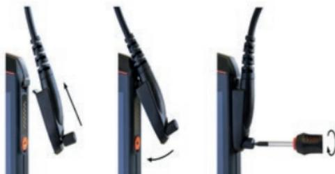
» W pokazany sposób podłączyć wtyczkę zatwierdzonego akcesoriu do interfejsu 13-pin ISM.
