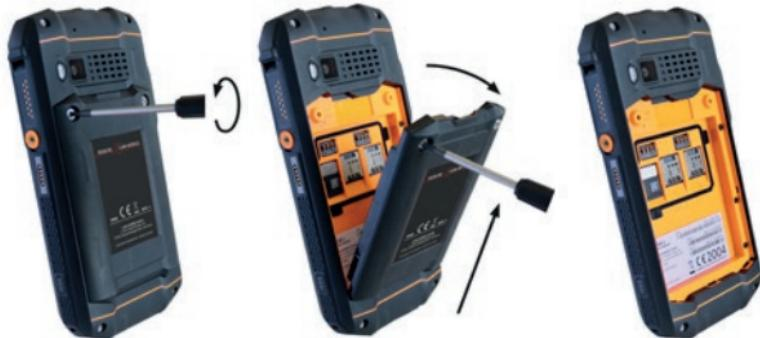
» Allentare le viti sulla batteria con il cacciavite Torx in dotazione.
